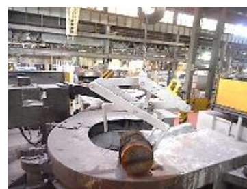
ホイストを上げるとクランパーが開いたまま上昇する
