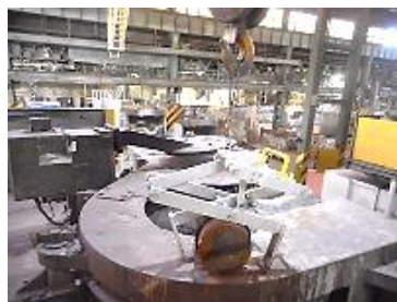
目的地まで運び、ホイストを下げると押し湯を離す、と同時にロックがかかる
