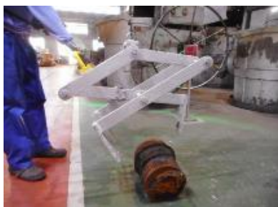
クランパーを押し湯の位置に合わせる
