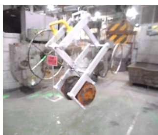
ホイストを上げるとクランパーが閉じ、押し湯をつかむ
