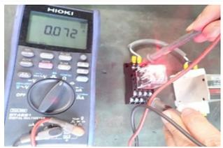
テスターの棒を押し当てて、接点抵抗値測定しているが、繰り返し動作の長時間作業の為、判定結果に個人差でムラが発生
