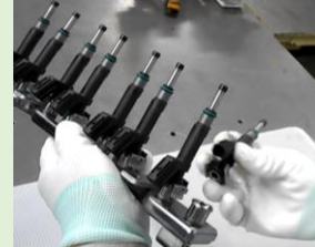
③フューエルチューブに インジェクターを組付け(8本)
