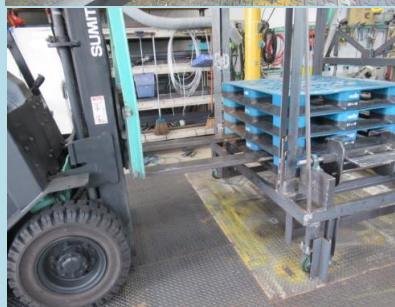
矯正ガイドを手動開閉し、 パレットを裏から直接セッ ト
