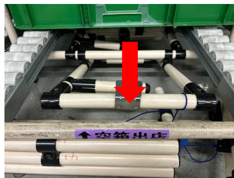
レバーに繋がった紐が引かれ 滑車を使い伝達方向を 90度変えストッパーが下がる
