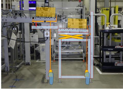
リフタ前のペダルを踏むとストッパ①が下降すると同時に後続ケース側のストッパ②が上昇しケースが切り分けられ先頭ケースはリフタへ後続ケースはストッパ②により待機先頭ケースがリフタへ到着するとストッパ①・②は復帰リフタ下降中はリフタ前のペダルがロックされ踏めない
