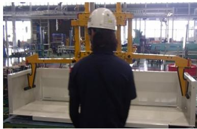
フロア一吊り治具装着後
