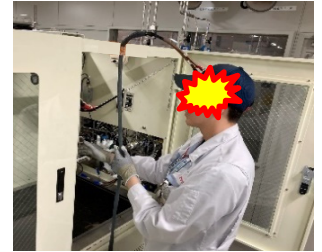
ケーブルが自重で落下し先端が飛び出してくる
