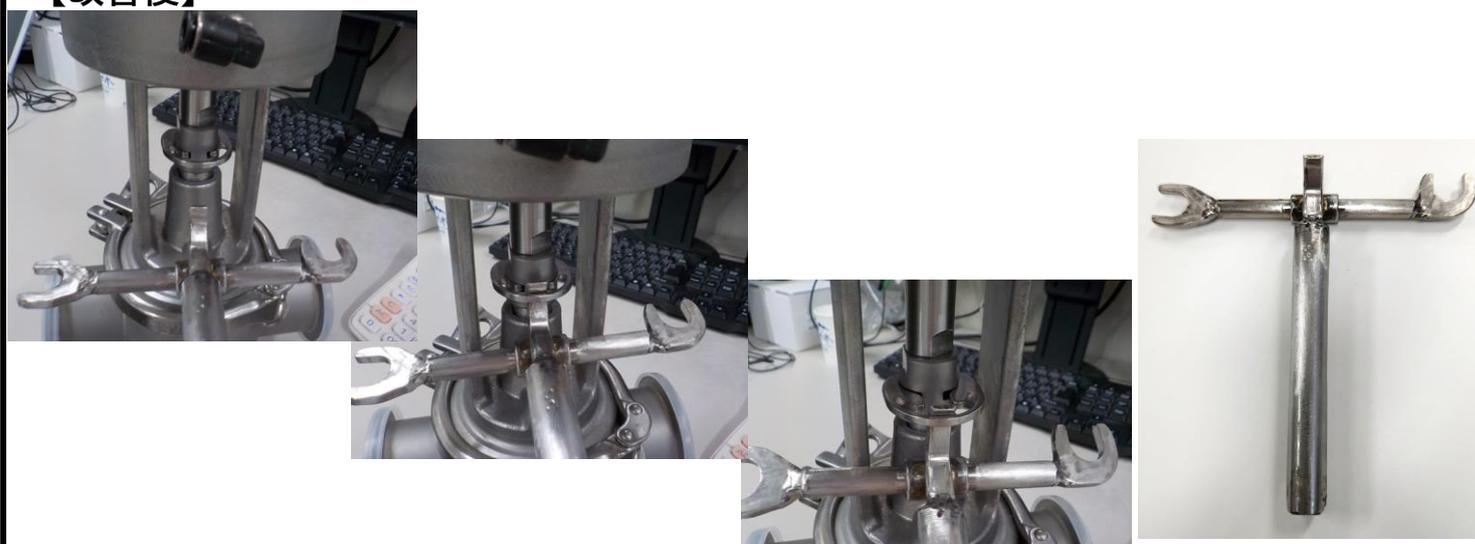
この治具を使う事でバルブの動作部に手指を入れずクリップを外す事が出来る。
