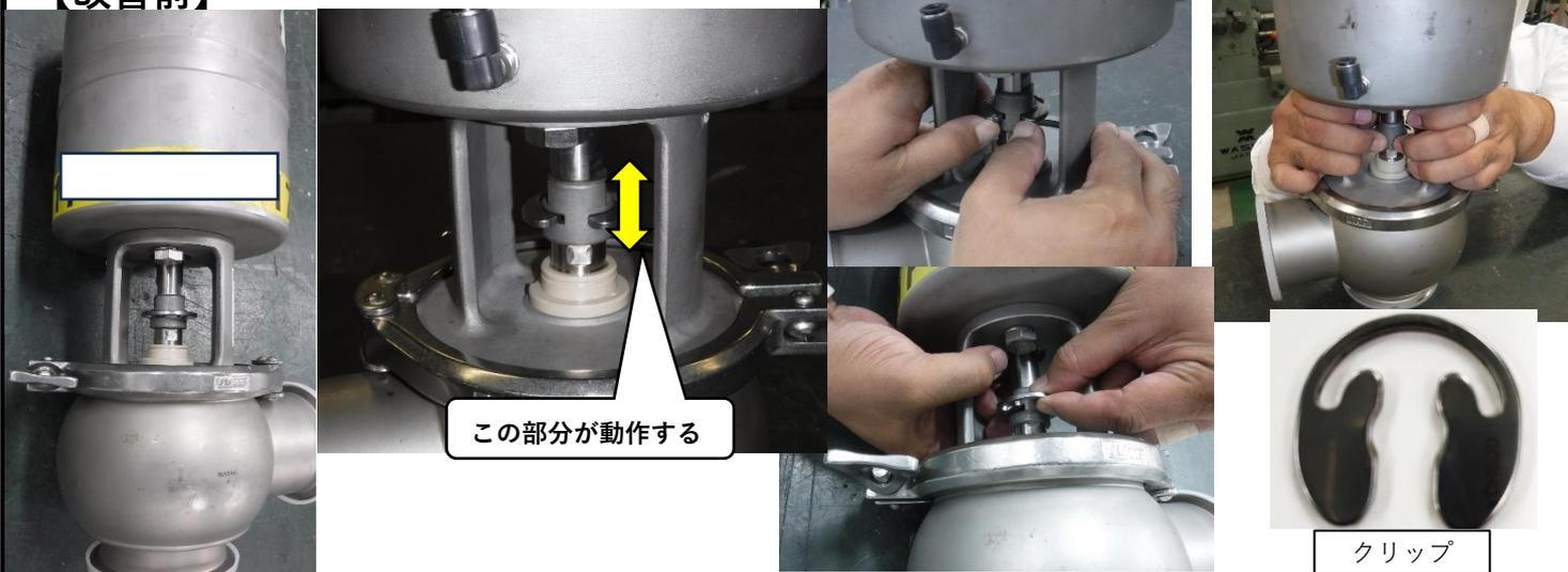
バルブの動作部に手指を入れてクリップを外している。
