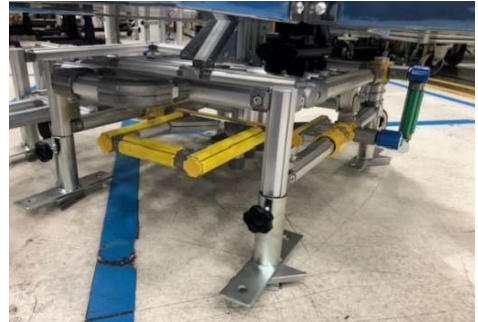
黄色レバーを押し引きすることで 主軸の角度調整可能 回転可能重量1kg～
