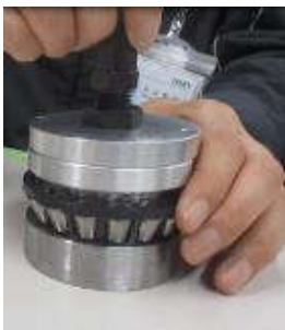
組付治具を保持器に セット。 (ころが組付治具に吸着)
