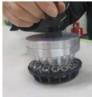
引き抜いた治具ところを 次の保持器にセットする。
