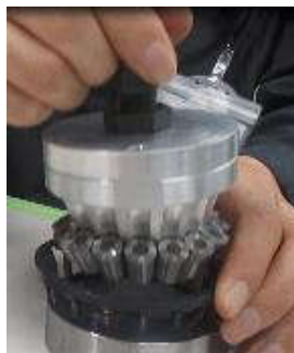
組付治具を持ち上げ、 ころを保持器から引き抜く。
