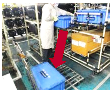
シューター中段から空ポリを運搬台車に降ろす。(屈み作業)
