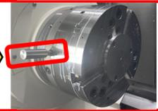
【ロボット起動】⇒ 生爪自動取り付け ※ロボット用交換ピン使用
