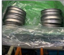
★キャップを置き場に揃えて置いているためロスが発生する。溜まったら上から降ろしている為落下したら危険である。
