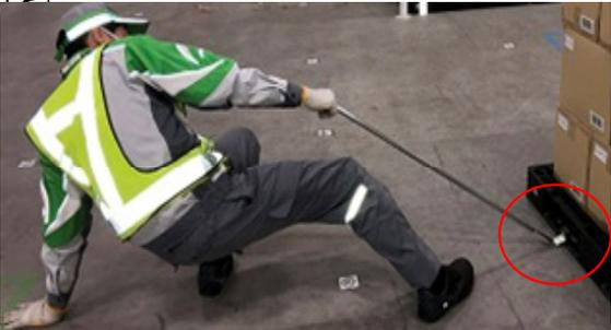
牽引する力が抜けると、手鉤棒の爪が落下してしまう。
