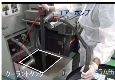
①クーラントタンクからエアポンプでクーラント液をドラム缶へ回収する。
