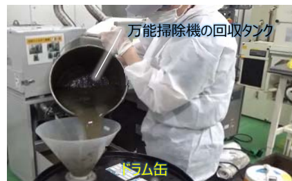
③万能掃除機で回収したクーラント液をドラム缶へ移し替える。
