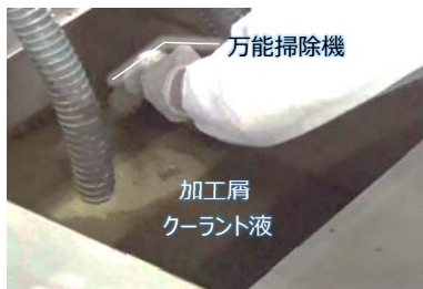
②万能掃除機で底に溜まった加工屑とクーラント液を回収する。
