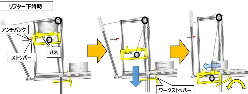
上昇したリフターはアンチバックで保持され、ワークを取るとバネでストッパーが解除され自重で下降する
