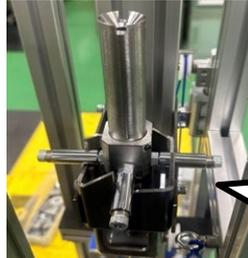
上下機構を回転機構に変換することで部品を拡散する事に成功
