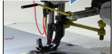
糸出が発生しないように糸の長さが調整されている
