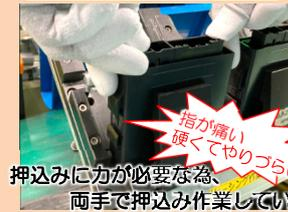
問題点 ①基板を押込む時、指に負荷がかかる ⇒ 災害リスク ②両手で1個ずつ押込んでいる ⇒ 持ち替えによる作業ロス
