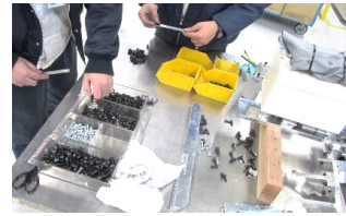
ボルト長をスケールで測定して仕分け
