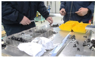
ボルトの径を目で見て仕分け
