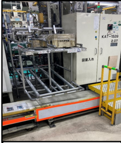
床面にコンベアがあり、部品を持ち上げ供給
