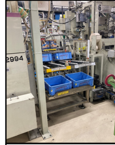
設備間より部品シュートに投入し供給
