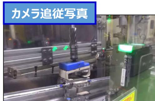
レールの傾斜角度違いでカメラが定位置で戻る
