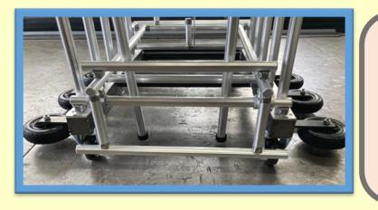
本体が傾いても支えられるように床面から10ミリの高さに 転倒防止兼誘導用タイヤを両サイドに取付
