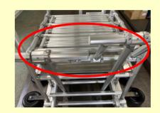
フットペダルを2つに分けること で床面の傾斜にも対応
