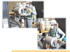
充填ボンベの乗せる作業は からくり機構で改善済みだが 横向きにする作業は人力
