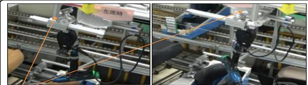
締付工具 吊下げBKT追従無効化による向き規制
