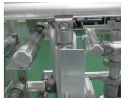
1段引き出す事で1段出しロックが回転し、他の引き出しのプッシュ機能を無効化、複数段同時に引き出しが引き出せなくなり台車転倒の危険性が無くなった。
