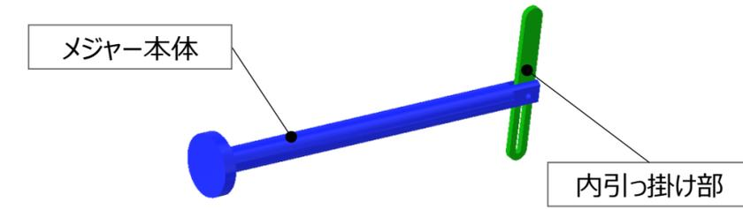
口金内面距離測定治具（洞窟メジャー）
