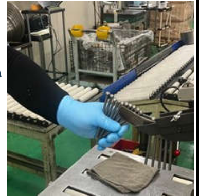
整列機に並んだリベットを取る
