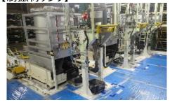
3つのタンクを使い回しながら 制振材を供給する
