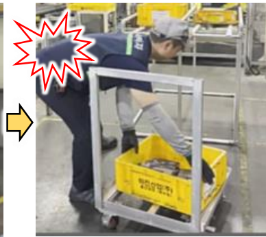
半製品ボックスに先入れする時、不安定な姿勢で重量物取扱(2段積載、3段積載など)作業進行
