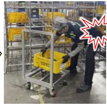
半製品ボックスに先入れする時、不安定な姿勢で重量物取扱(2段積載、3段積載など)作業進行
