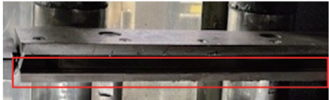
スライドレールが摩耗する部分のみ交換出来る様に改造 (赤枠部分)
