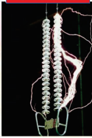
商用周波フラッシュ オーバ電圧試験
